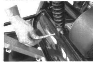
4. Лыжный модуль, установленный на мотобуксировщик, будет иметь вид, как указано на рисунке. После этого нужно подключить органы дистанционного управления двигателем (см. руководство по эксплуатации двигателя мотобуксировщика).
